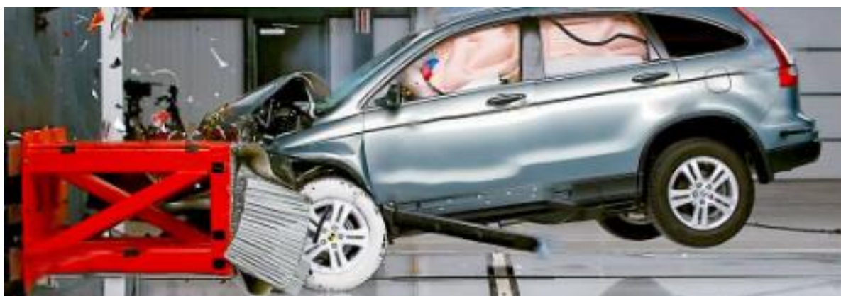
Слика 18. Оштећење возила у судару при брзини од 64.37 km/h на краш-тесту
