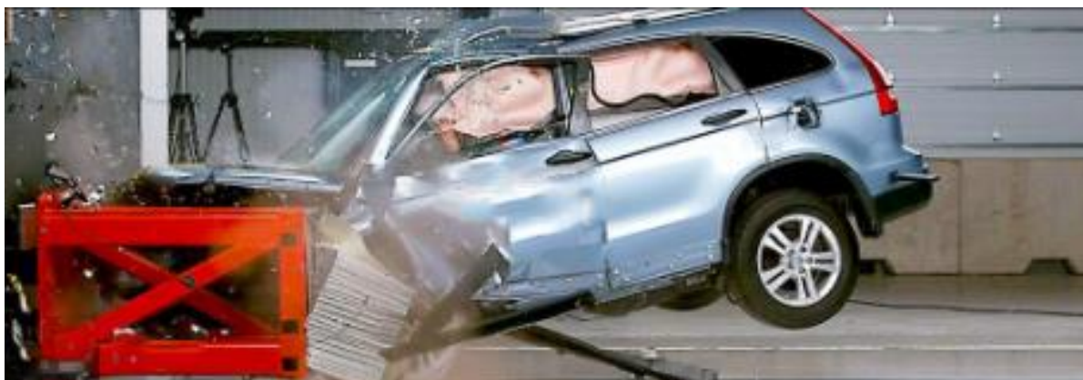
Слика 19. Оштећење возила у судару на краш-тесту при брзини од 90.12 km/h
